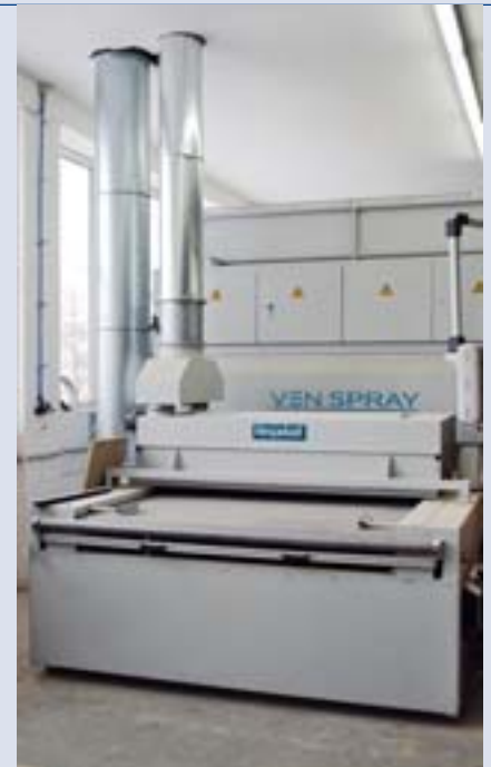
Der 2009 angeschaffte Spritzautomat von Venjakob sorgt zusammen mit dem Schleifautomaten für hohe Oberflächenkompetenz
