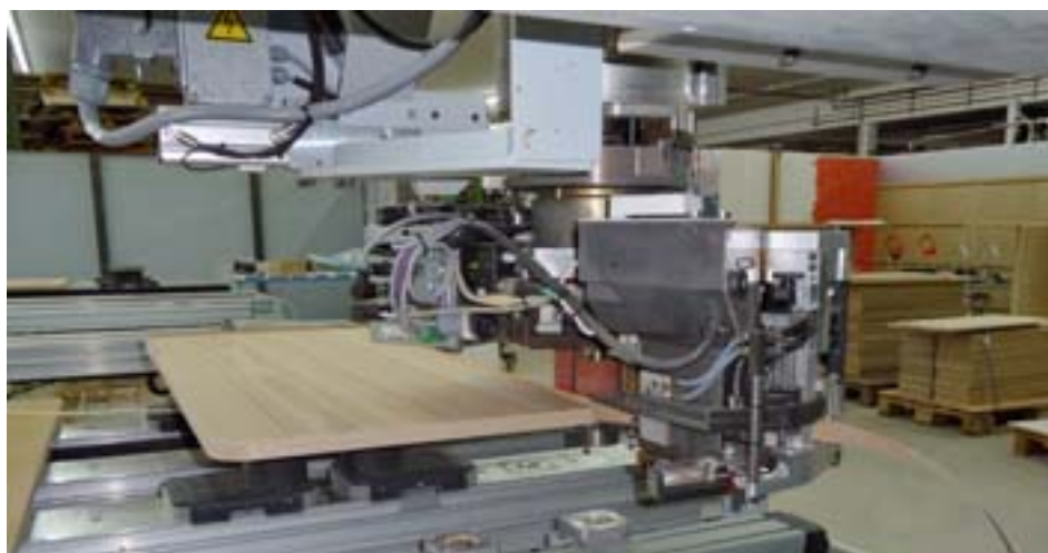
Das Kantenanleimaggregat auf dem CNC-Bearbeitungszentrum sorgt für hohe Flexibilität in der Fertigung (Fotos: Christian Nördemann, Costa Schleifmaschinen GmbH, Tischlerei Schröder)
