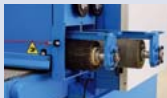
... schnell zu wechselnden Bürsten im Auslauf der Maschine (kleines Bild links) ermöglichen den universellen Einsatz bei der Platten- wie auch bei der Massivholzbearbeitung. Kleines Bild rechts: Werkstückerkennung im 10 mm-Raster
