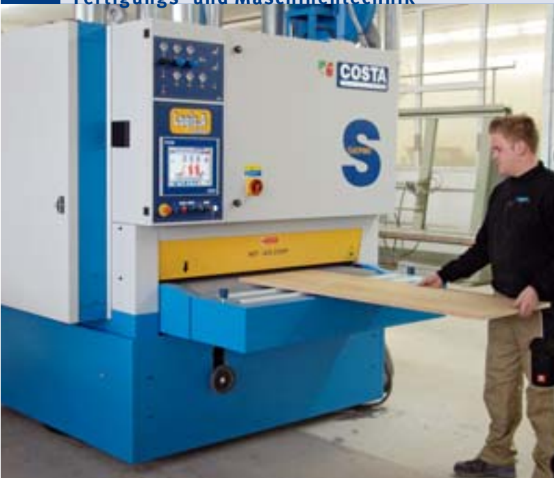
Mit Anschaffung des Schleifautomaten und der damit erzielbaren Qualität hat Ulrich Schröder eigenen Angaben zufolge die „Angst vor Hochglanz verloren“. Doch die Maschine kann mehr: Die drei Schleifaggregate sowie die beiden ...
